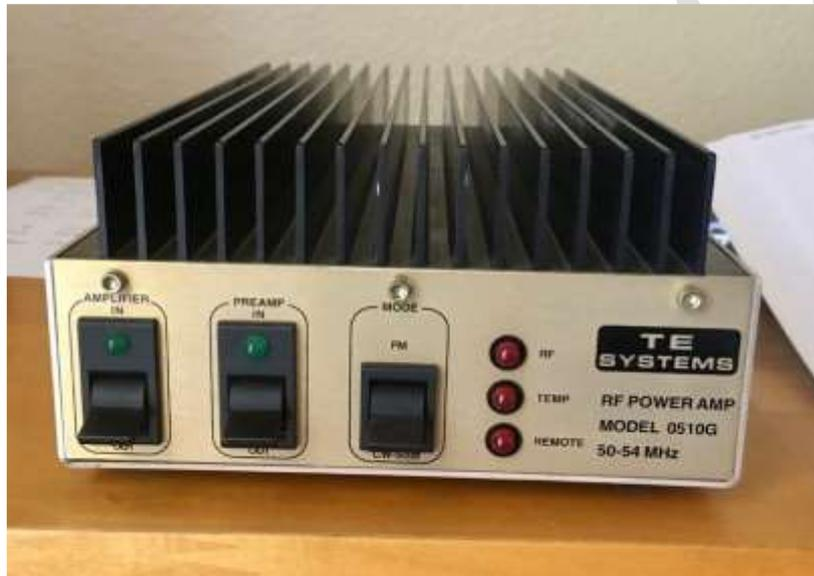
Les amplificateurs à semi-conducteurs sont un excellent point de départ. J'utilise un TE Systems 0510G qui fournit 170 watts en sortie pour 10 watts en entrée. Il possède également un préamplificateur intégré. Il existe des versions plus puissantes, ce qui est tentant. Mais j'ai choisi celle-ci pour mes opérations de VHF Limited Rover. Cette catégorie de concours a une puissance maximale de 200 watts sur six mètres. Une puissance RF plus faible simplifie également les besoins en courant continu.
