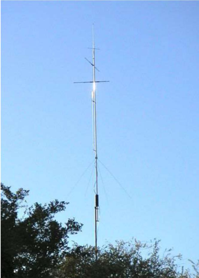
En 2011, j'ai acheté un Cushcraft MA6V vertical qui couvre 20 à 6 mètres. Cela a ajouté à mes capacités de concours HF. J'ai évité d'utiliser cette antenne sur six car au début j'avais le dipôle et plus tard un Moxon suivi d'un Yagi à 3 éléments.
