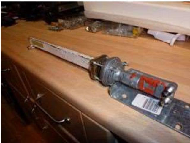
Antenne à guide d'ondes à fente de 10 GHz
