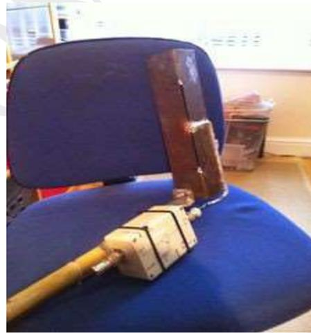
Antenne à fente ADM 1296MHz (Omni Horizontal)
